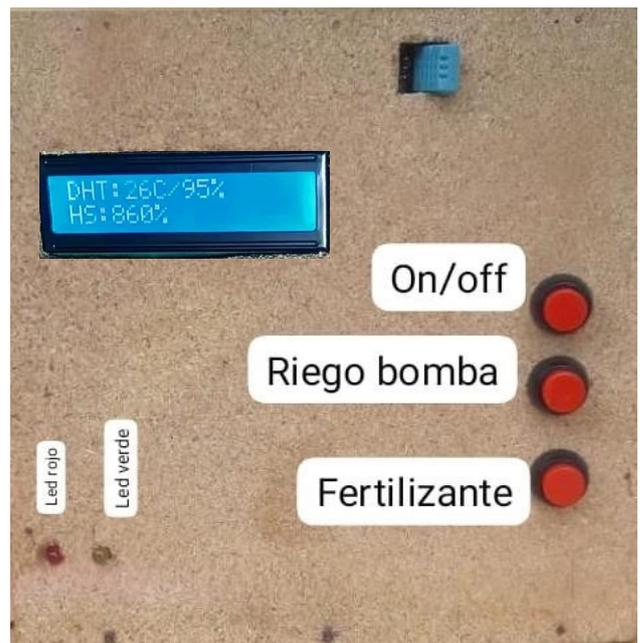
**Figura 7.** Prototipo de control de riego
